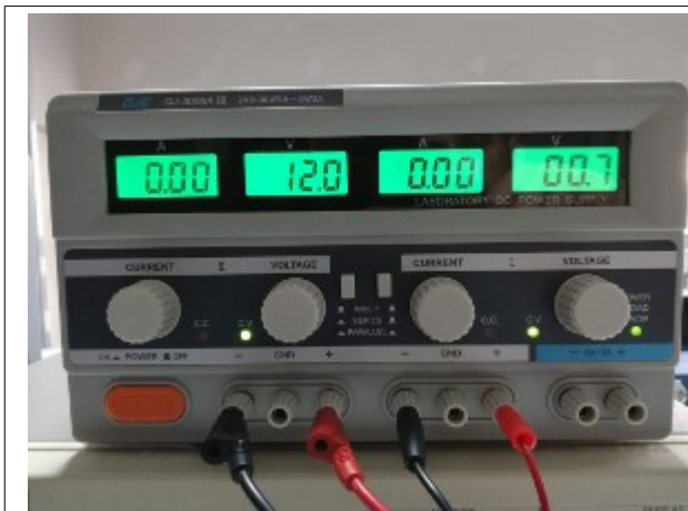
Power supply V_{cc}=12V ; V_{contr}=0,7V
