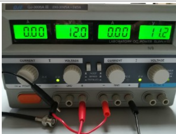
Power supply V_{cc}=12 V; V_{contr}=11,2 V
